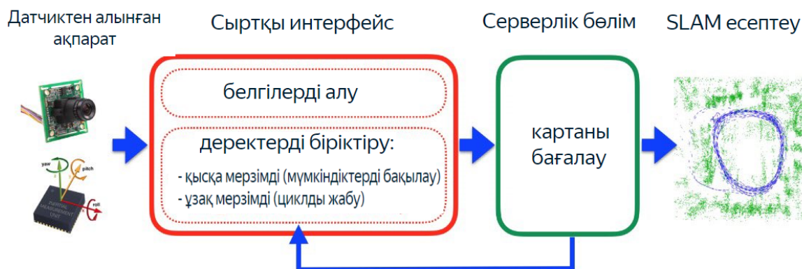
Сурет 1.4 – SLAM жүйесінің алгоритмі
