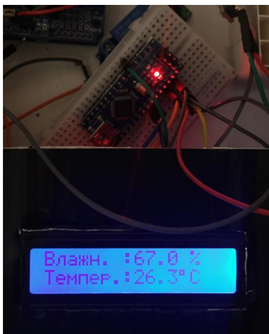
Сурет 2.3 – Arduino Nano микроконтроллерінде құрастырылған бақша роботындағы метеостанция
